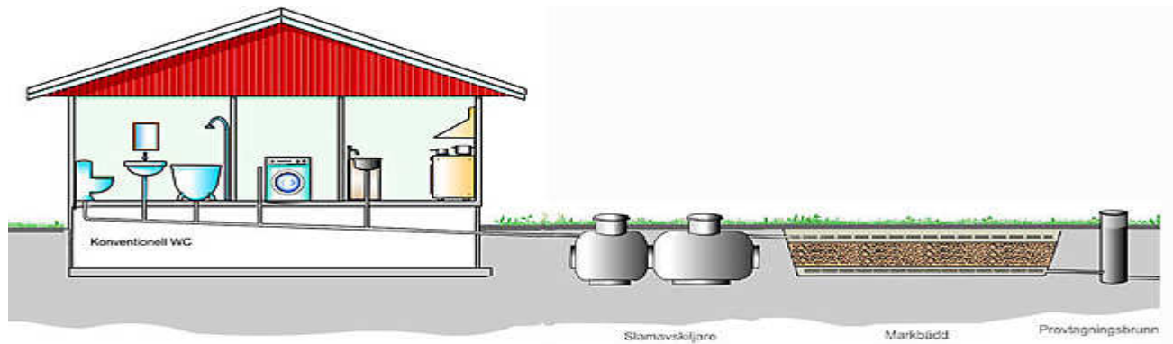
Principskiss på markbädd ( www.avloppsguiden.se )
