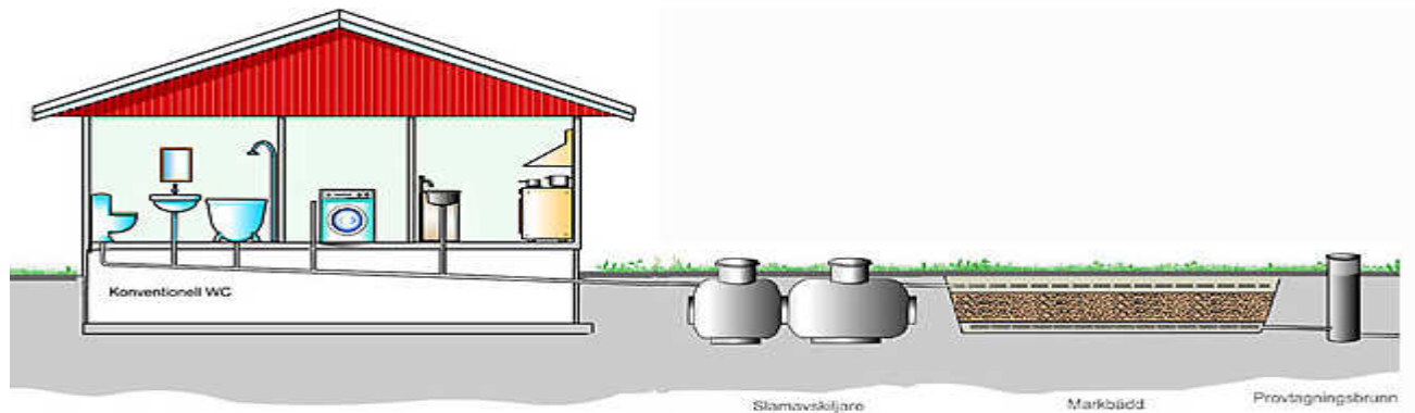
Principskiss på markbädd ( www.avloppsguiden.se )
