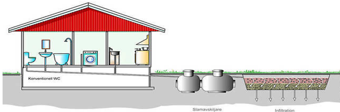
Principskiss för infiltration ( www.avloppsguiden.se )
